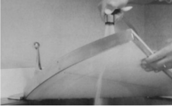
Şekil 9. Bir enerji çarkının ısı aktarım bölmesinin temizlenmesi
