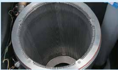
Eşanjörün dış gövdesi 1.4571 tipi paslanmaz çelik, iç gövdesi alüminyum-silisyum-magnezyum alaşımı, ekstrüzyon dökümdür. Düşey kanallı silindirik formu eşanjörün, pürüzsüz yüzeyi, kendini temizleme fonksiyonuyla ömür boyu yüksek verim sağlar.
