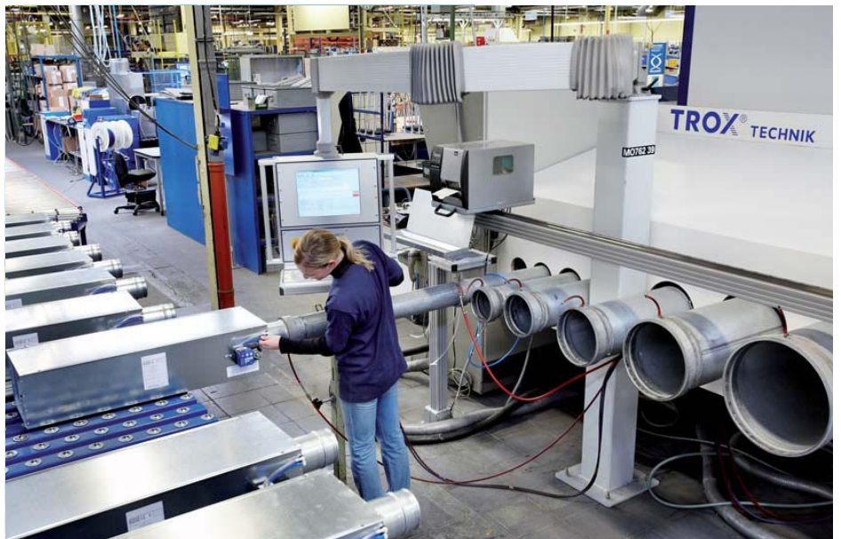
Değişken hava akışlı/debili kontrol ünitesi (VAV Box) imalatı ve ayarlanması
