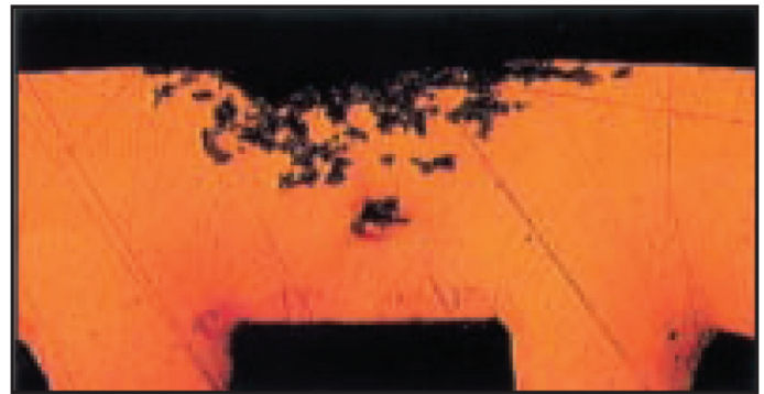
Şekil 2. Karıncalanma Tipi Korozyon Nedeniyle Oluşan Tüneller
