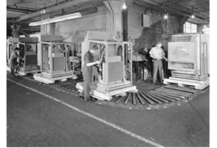
1944 yılı. Carrier'ın Sirakuzalı'daki üretim hattında deniz kuvvetleri için yapılan büyük kapasiteli soğutma üniteleri
