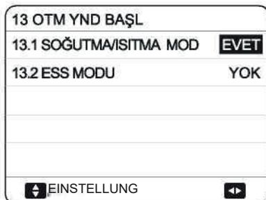
Die Funktion AUTM YND START wird im Falle eines Stromausfalls auf die Einstellungen der Benutzeroberfläche angewendet. Wenn diese Funktion deaktiviert ist, startet die Einheit nicht automatisch neu, wenn die Stromversorgung nach einem Stromausfall wiederhergestellt wird.
