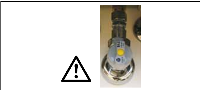
Resim: Gaz bağlantısı Gaz sızıntısı durumunda, zehirlenme ve patlama tehlikesi vardır.
