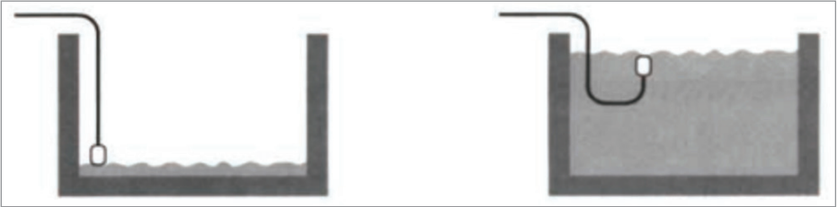
Depo boş. Hidrafor çalışmaz.
