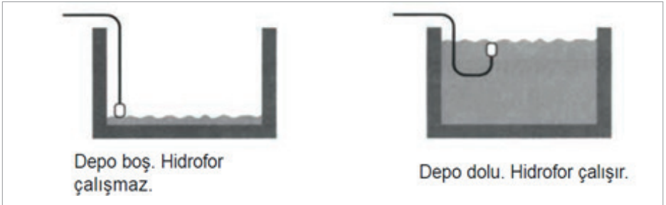
Şekil 2: Su Seviye Flatörünün Depoya Yerleştirilmesi
