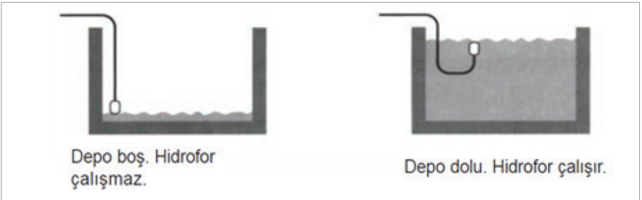
Şekil 2: Su Seviye Flatörünün Depoya Yerleştirilmesi
