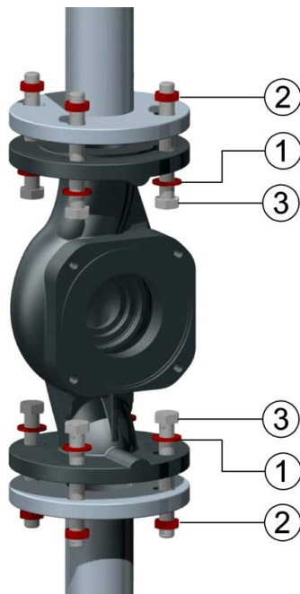
Abbildung 6.5 Pumpenmontage mit Flanschanschluss
