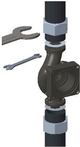
Abbildung 6.4: Pumpenmontage mit Gewindeanschluss
