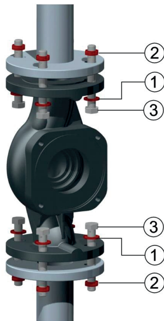
Abbildung 6.4: Reihenfolge von Unterlegscheibe, Schraube und Muttern
