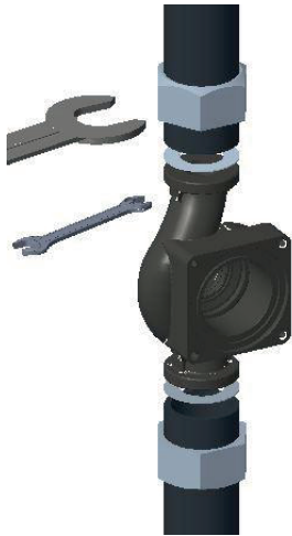
Abbildung 6.4: Pumpenmontage mit Gewindeanschluss
