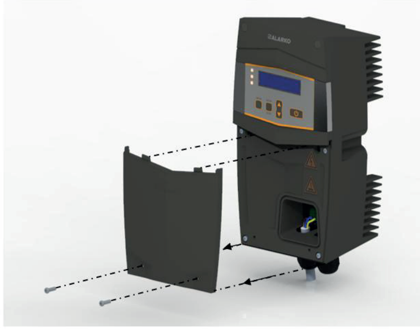
Şekil 6.8: Alt Kapağın Çıkarılması
