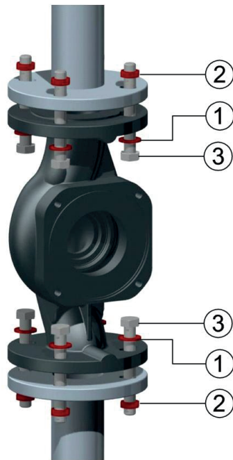
Şekil 6.4: Flanş Bağlantılı Pompa Montajı
