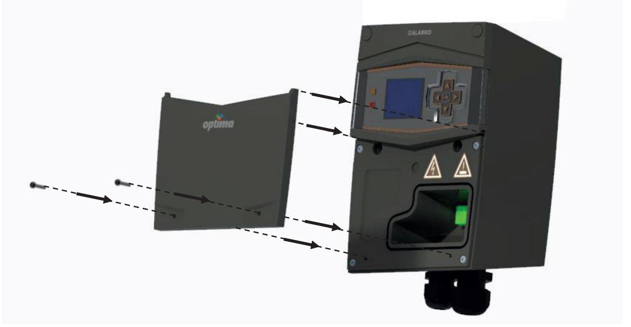
Şekil 6.11: Alt Kapağın Takılması
