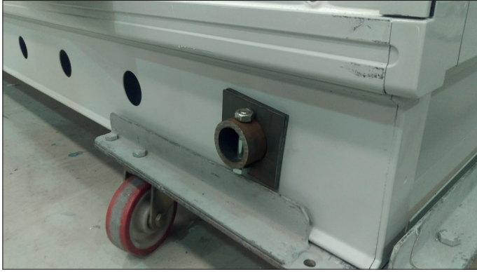
Şekil 7. Kaldırma çubuklarının bağlanması - 3
