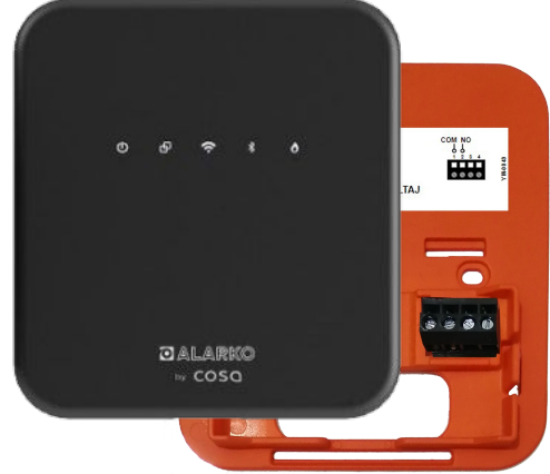
Kombi ünitesi ve duvar aparatı
