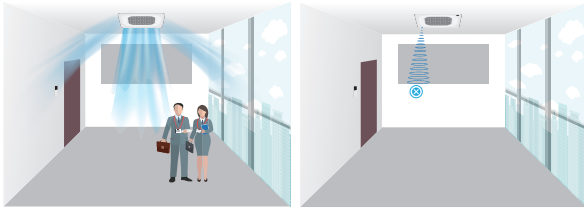
İç ünite insan vücudunu tespit ettiğinde otomatik olarak çalışır
