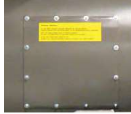
Müdahale kapağı (inspection hatch)
